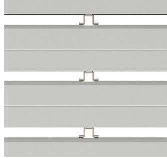
Les lames mobiles sont reliées entre elles par des **crochets solides** en acier au nickel-chrome. Ceux-ci assurent un écart de 9 mm entre les lames, pour une excellente ventilation et un passage optimal de la lumière. En position fermée, le volet garantit une isolation contre la lumière et une insonorisation parfaites.
