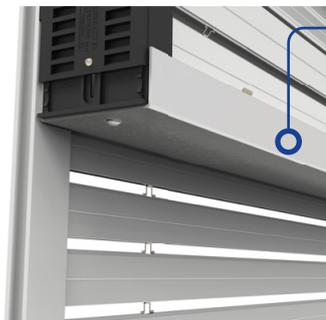
**Plafonnet inférieur** de couverture de la traverse accueillant le paquet en aluminium anodisé ou thermolaqué. Hauteur standard de 40 mm (pour la version à 2 lames) et de 100 mm (pour la version à 3 lames). Au-delà de 2000 mm de largeur, la tôle est toujours livrée en 100 mm de hauteur.
