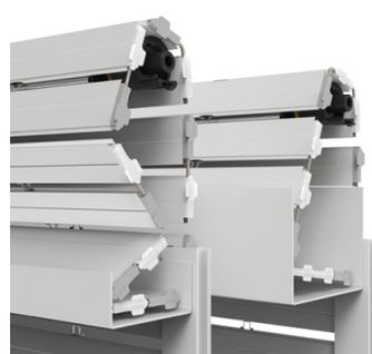
**Führungsgleiter** aus Polyamid sorgen für ein optimales Gleiten in der Führungsschiene. Sie sind so miteinander verbunden, dass das gleichzeitige Zusammenfallen von zwei oder drei Stäben in der Paketschale möglich wird. Die Führungsgleiter sind verstärkt und werden zusätzlich in die Stabenden eingestanz (2-Stab-Version) oder mittels rostfreier Klammer fixiert (3-Stab-Version) um optimalen Windwiderstand des Behänge zu gewährleisten.
