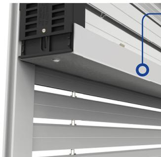
Untere **Abdeckung** für die Paketschale aus thermolackiertem Aluminium. Standardhöhe 40 mm (2-Stab-Version) und 100mm (3-Stab-Version). Bei Konstruktionsbreiten von über 2'000 mm wird eine verstärkte Abdeckung im Mass 100 mm geliefert.
